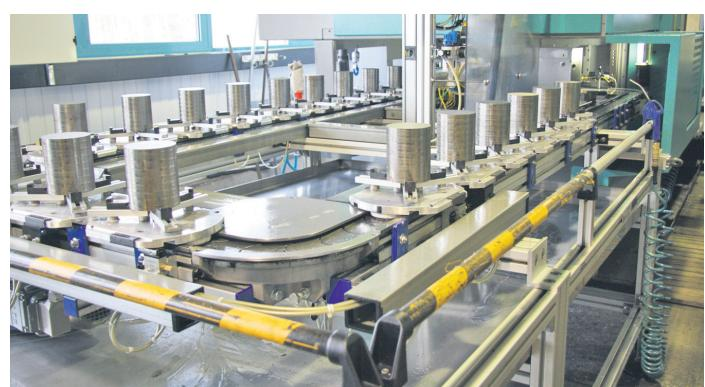
Bei Loesch in Gschwend: Vertikalbearbeitung von Hydraulik-Kolben.
